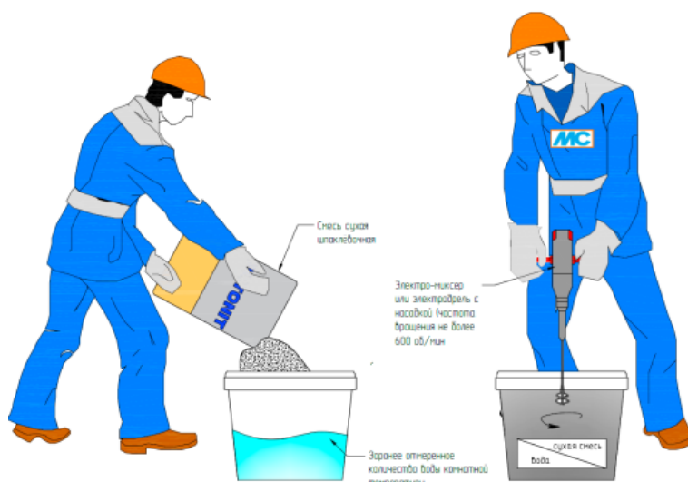
Рис. 7. Организация работ по затворению сухой шпаклевочной смеси
