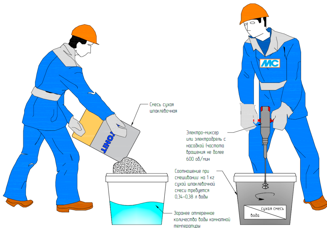
Рис. 27. Организация работ по затворению сухой шпаклевочной смеси
