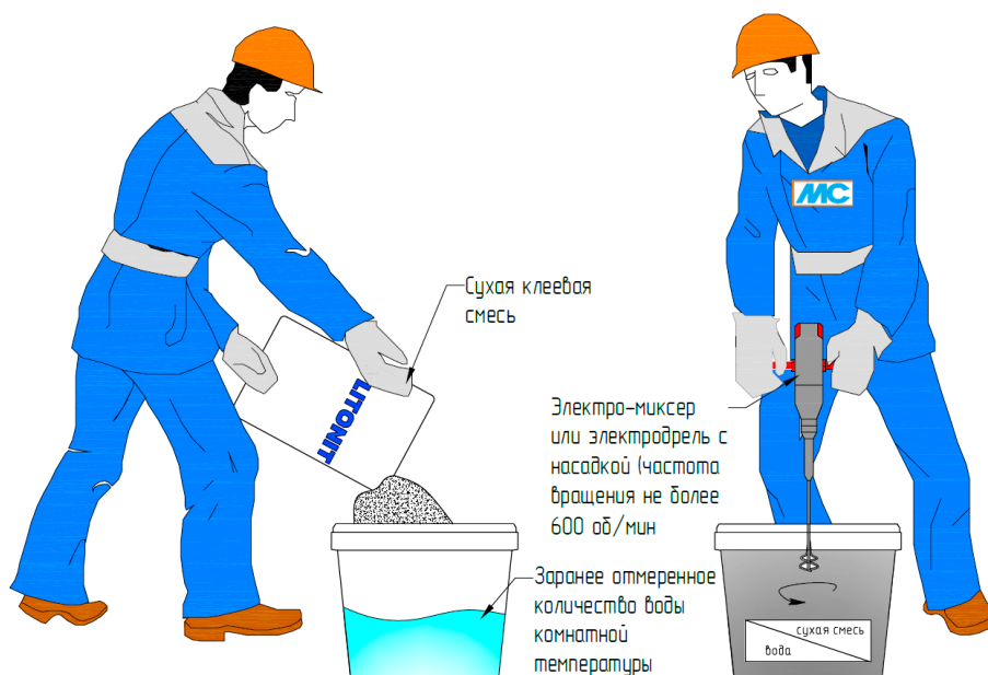
Рис. 34. Организация работ по затворению сухой клеевой смеси
