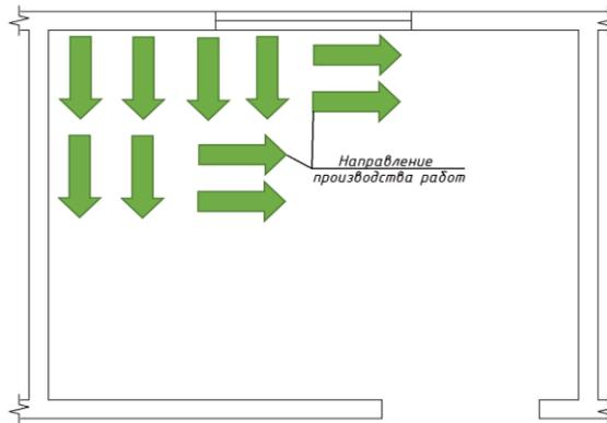
2. Укладка плитки индивидуальной формы для создания рисунка.
