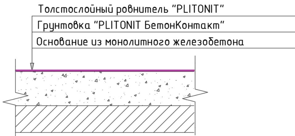
Сечение готового покрытия толстослойного ровнителя.
