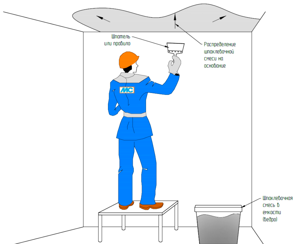
Рис. 16. Организация работ по нанесению шпаклевочной смеси
