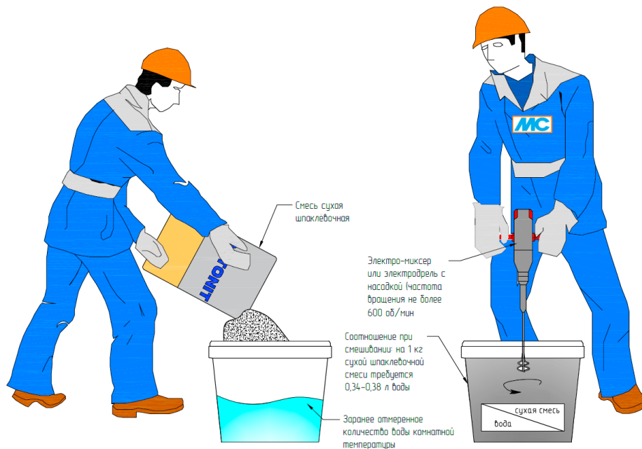
Рис. 29. Организация работ по затворению сухой шпаклевочной смеси
