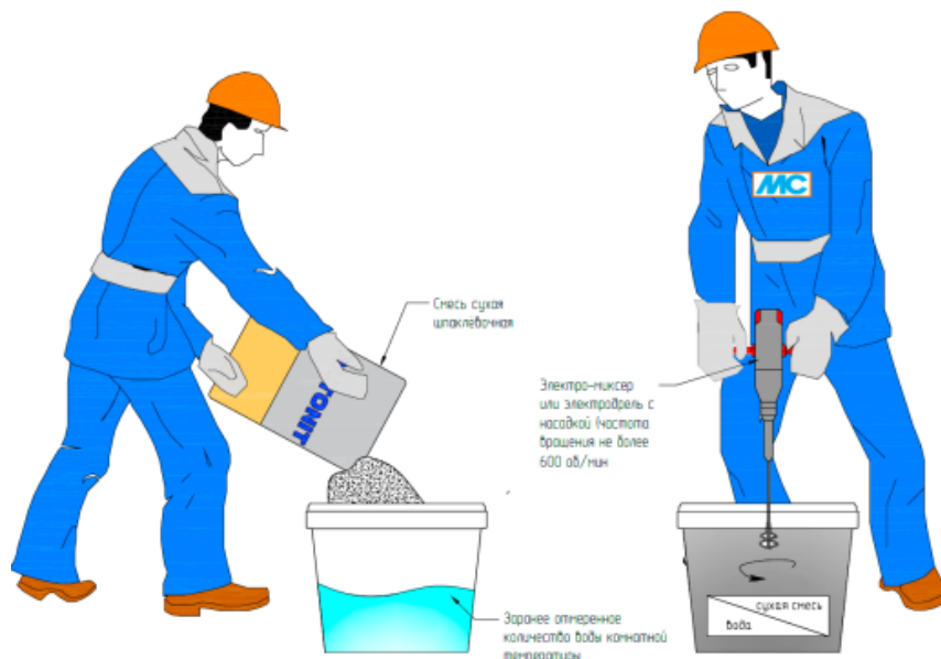
Рис. 7. Организация работ по затворению сухой шпаклевочной смеси
