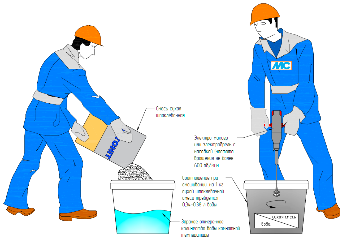
Рис. 27. Организация работ по затворению сухой шпаклевочной смеси
