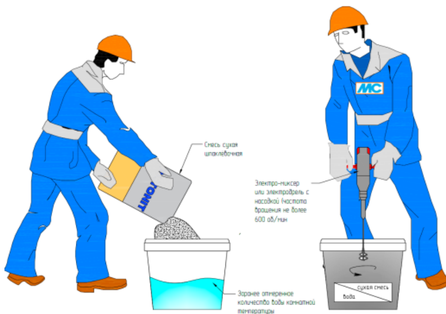
Рис. 16. Организация работ по затворению сухой шпаклевочной смеси
