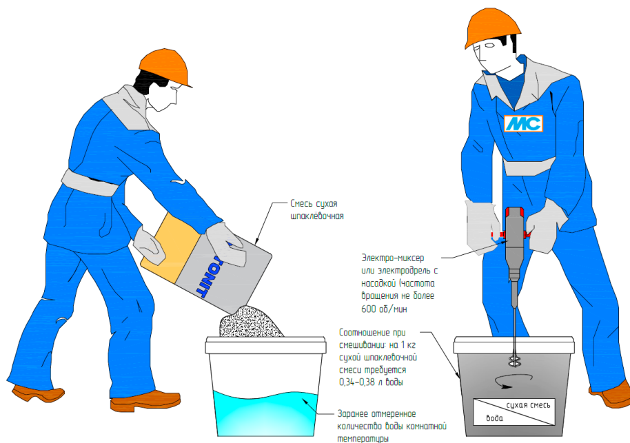
Рис. 30. Организация работ по затворению сухой шпаклевочной смеси
