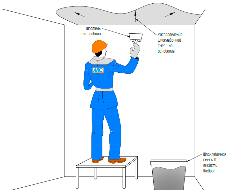
Рис. 9. Организация работ по нанесению шпаклевочной смеси
