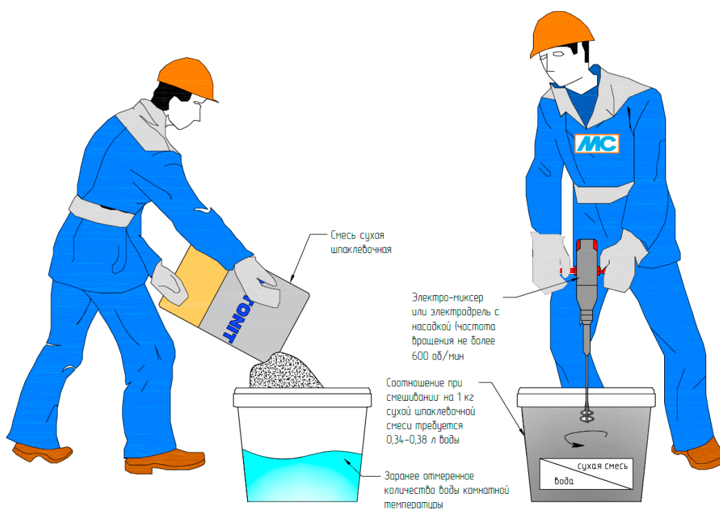
Рис. 20. Организация работ по затворению сухой шпаклевочной смеси
