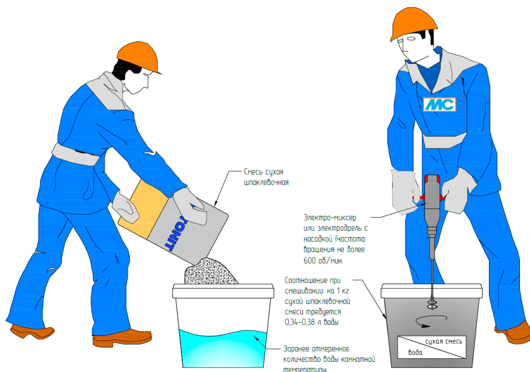
Рис. 20. Организация работ по затворению сухой шпаклевочной смеси
