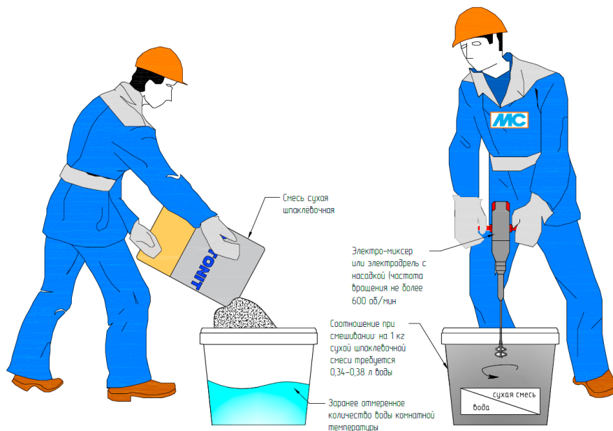
Рис. 28. Организация работ по затворению сухой шпаклевочной смеси
