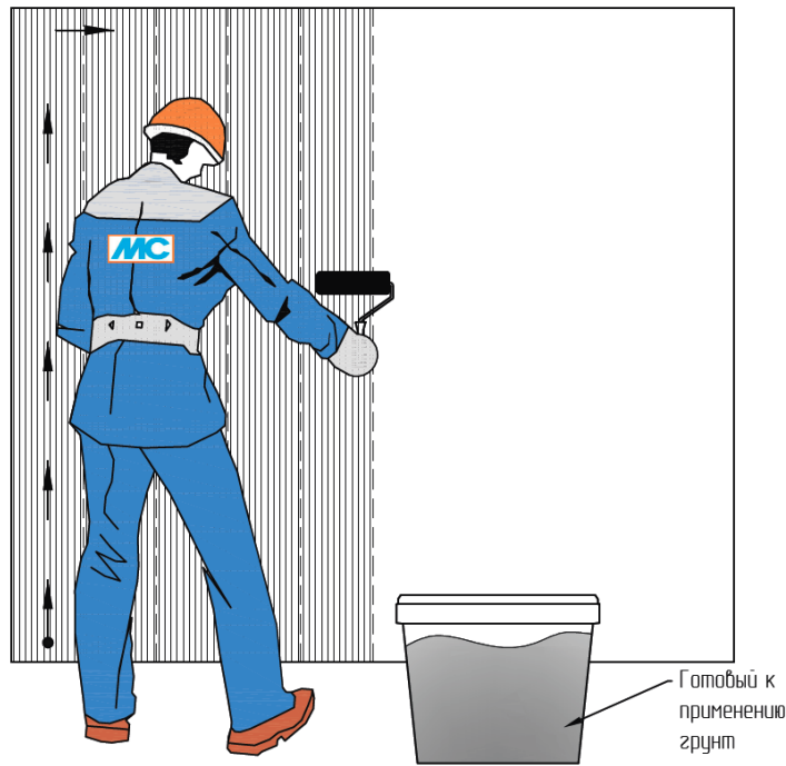
Рис. 21. Схема организации работ по нанесению грунта на основание
