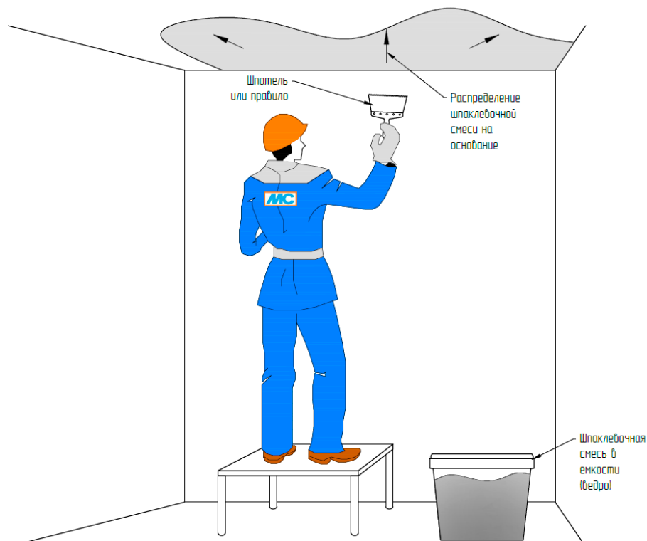
Рис. 16. Организация работ по нанесению шпаклевочной смеси
