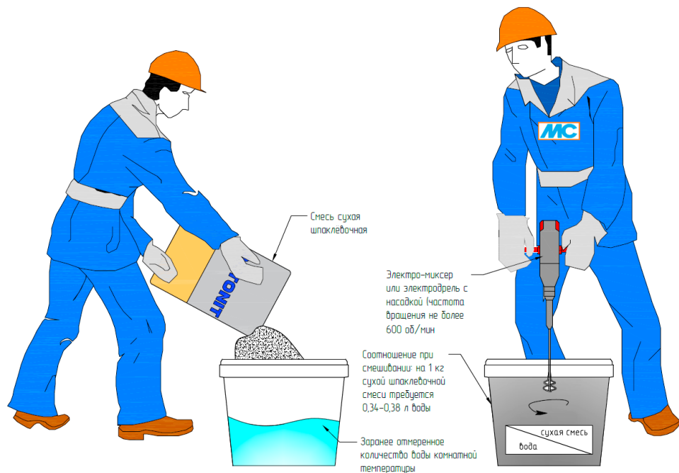
Рис. 15. Организация работ по затворению сухой шпаклевочной смеси
