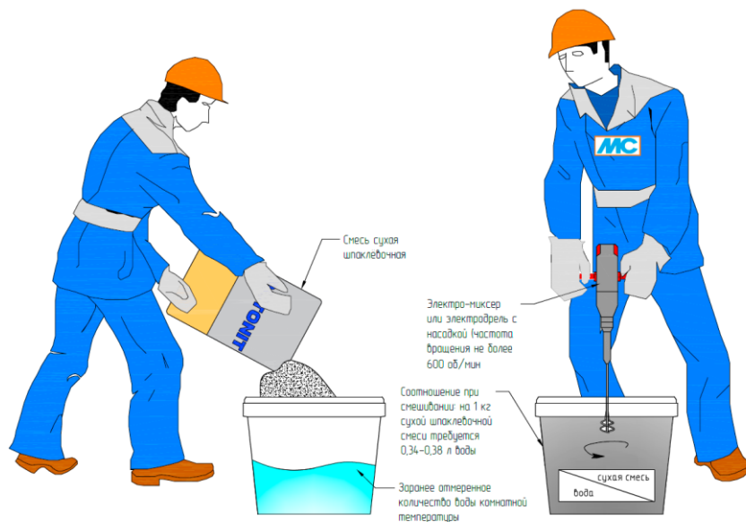
Рис. 21. Организация работ по затворению сухой шпаклевочной смеси
