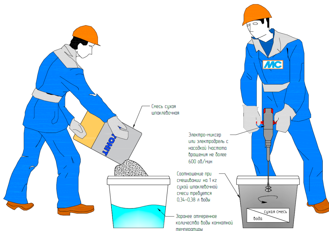
Рис. 8. Организация работ по затворению сухой шпаклевочной смеси
