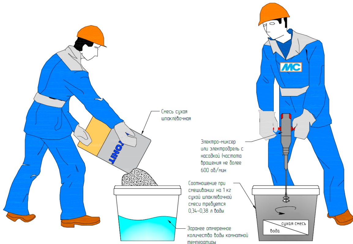
Рис. 27. Организация работ по затворению сухой шпаклевочной смеси
