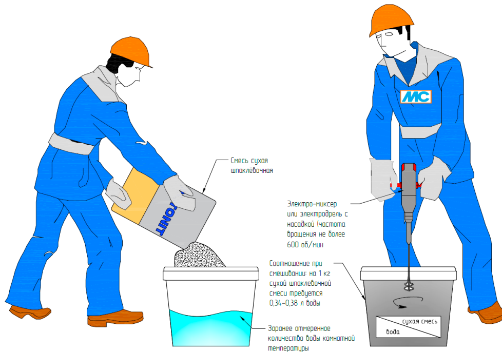
Рис. 27. Организация работ по затворению сухой шпаклевочной смеси
