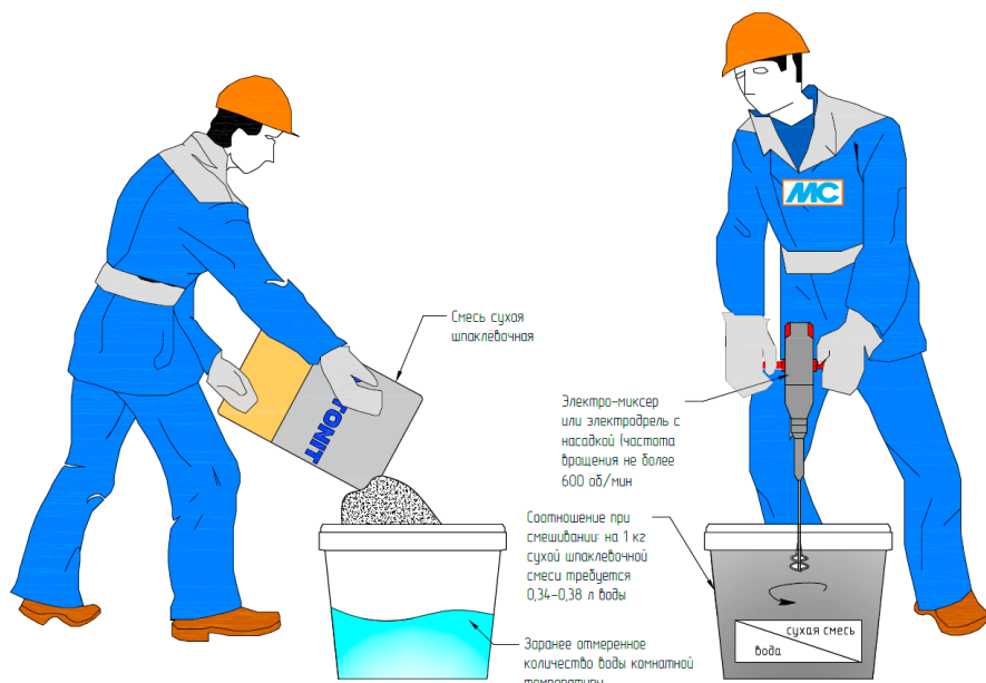
Рис. 28. Организация работ по затворению сухой шпаклевочной смеси
