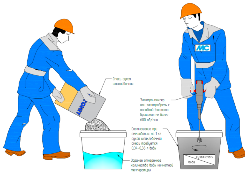
Рис. 21. Организация работ по затворению сухой шпаклевочной смеси
