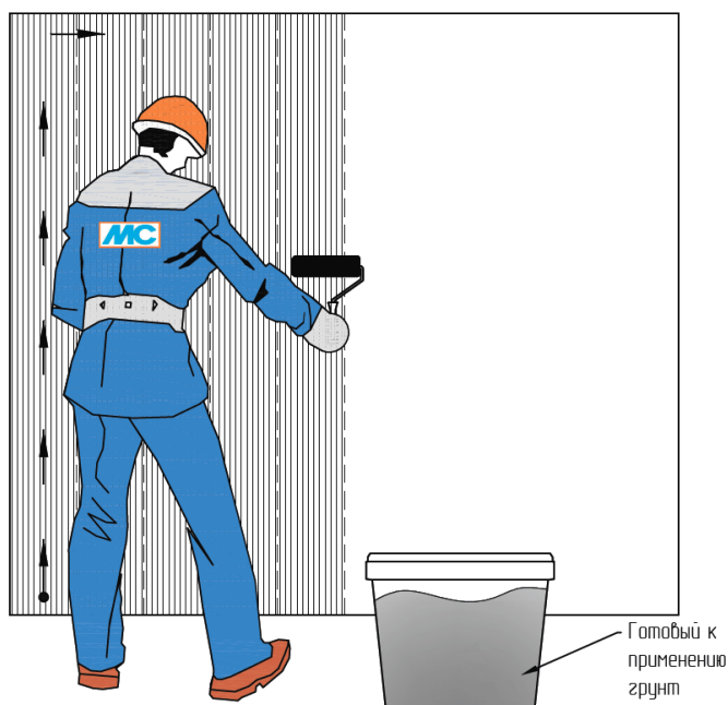
Рис. 20. Схема организации работ по нанесению грунта на основание
