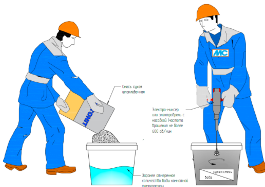
Рис. 11. Организация работ по затворению сухой шпаклевочной смеси
