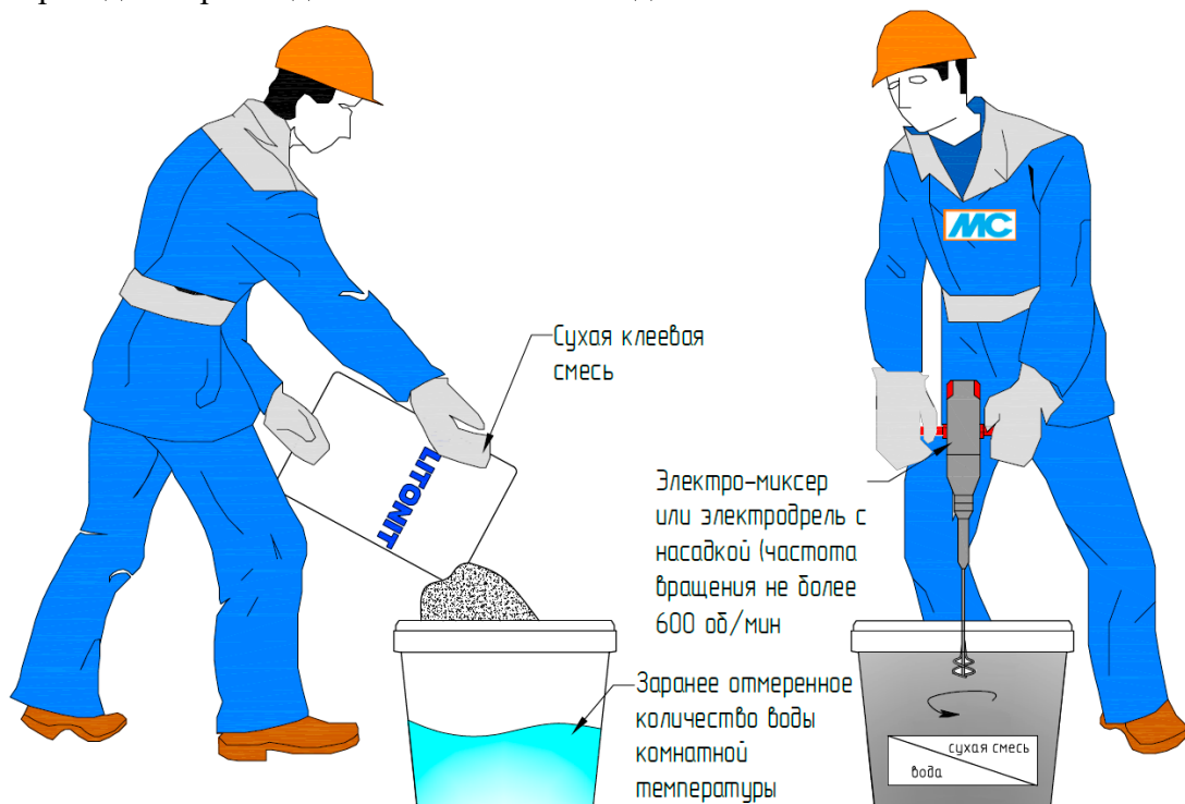
Рис. 13. Организация работ по затворению сухой клеевой смеси
