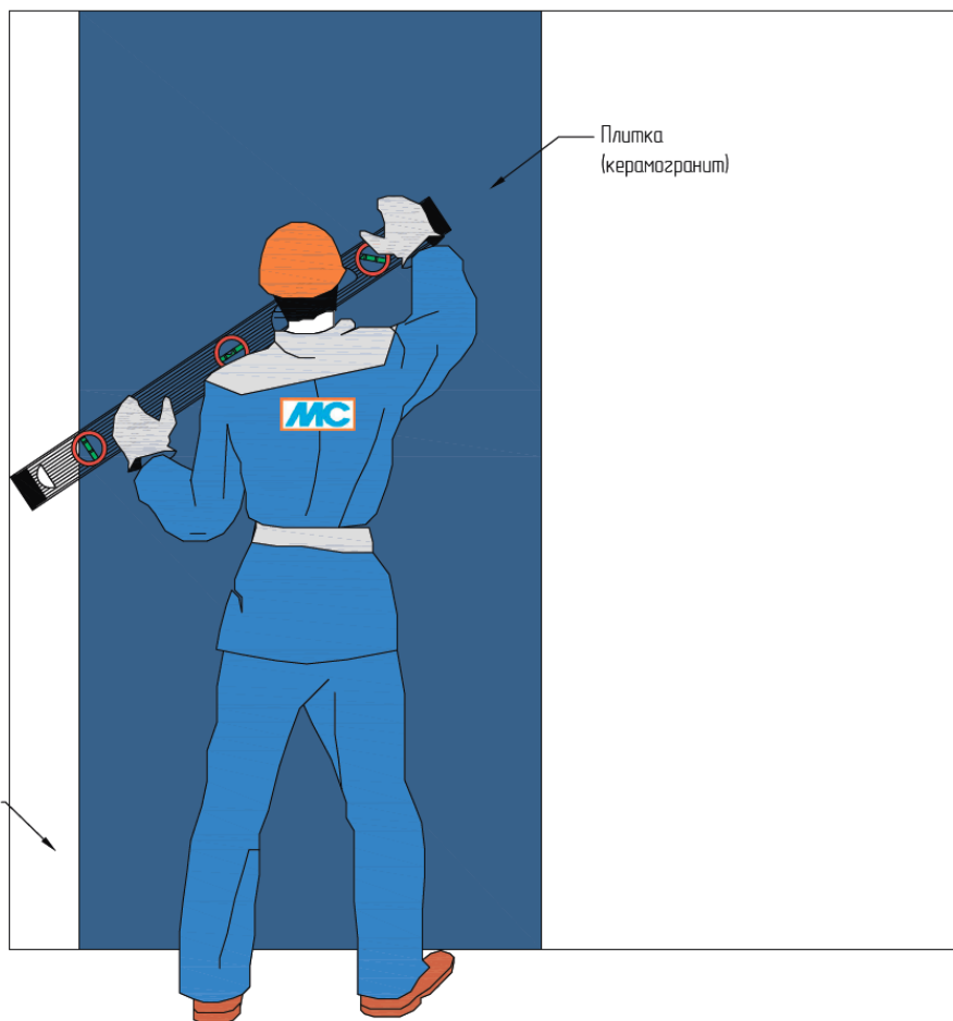
Рис. 32. Проверка облицовки при помощи уровня
