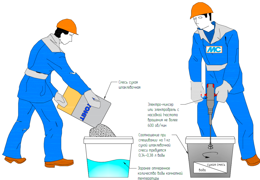
Рис. 30. Организация работ по затворению сухой шпаклевочной смеси Растворную смесь наносится вручную с помощью правила или шпателя (см. Рис. 31). Правило или широкий шпатель используется для нанесения готовой шпаклевки на стену и узкий шпатель для укладки смеси из емкости на инструмент нанесения.
