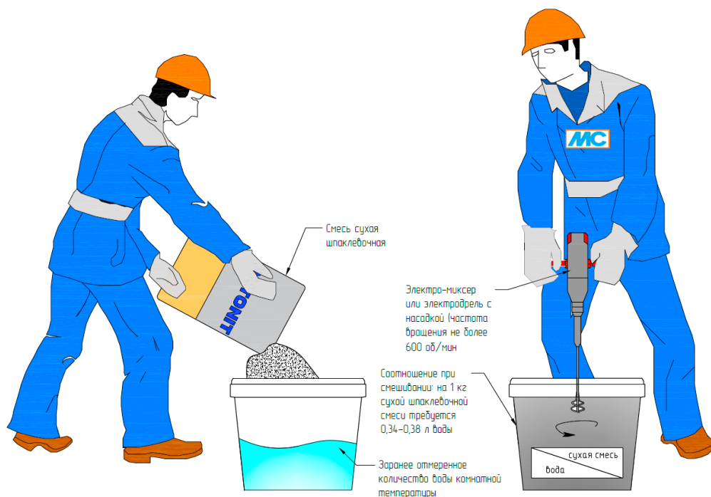
Рис. 16. Организация работ по затворению сухой шпаклевочной смеси
