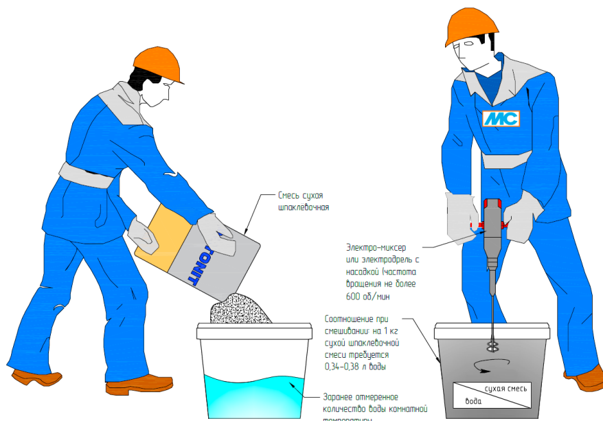
Рис. 28. Организация работ по затворению сухой шпаклевочной смеси
