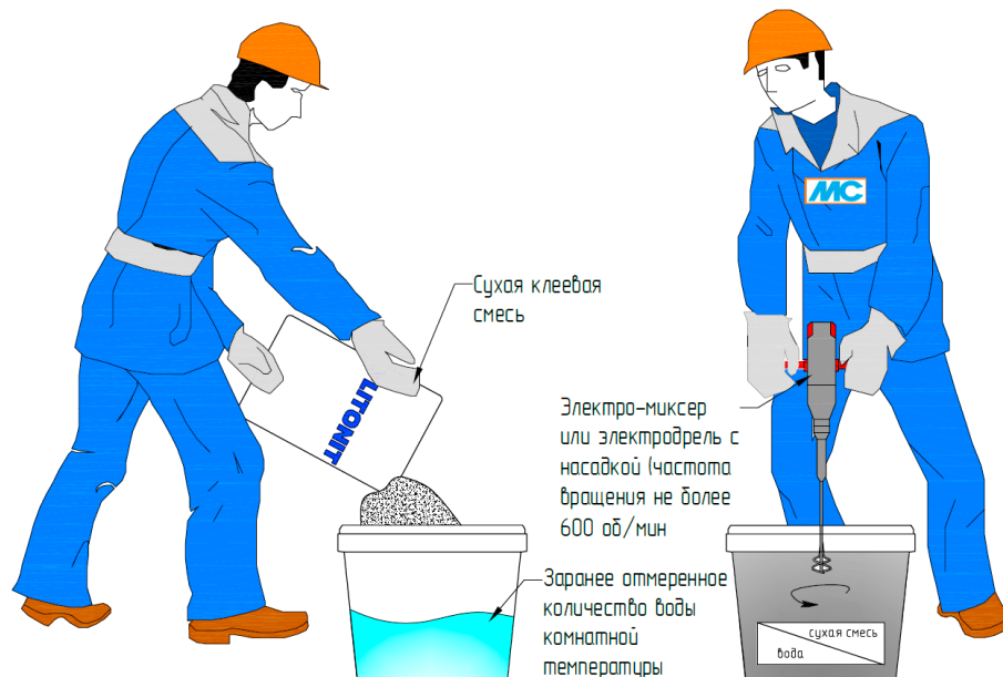
Рис. 29. Организация работ по затворению сухой клеевой смеси
