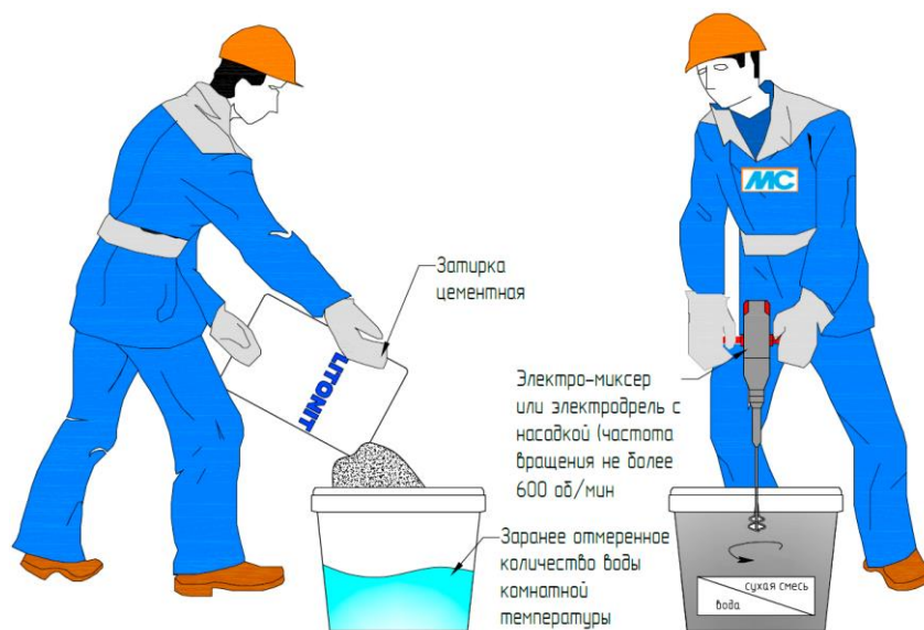
Рис. 32. Приготовление состава
