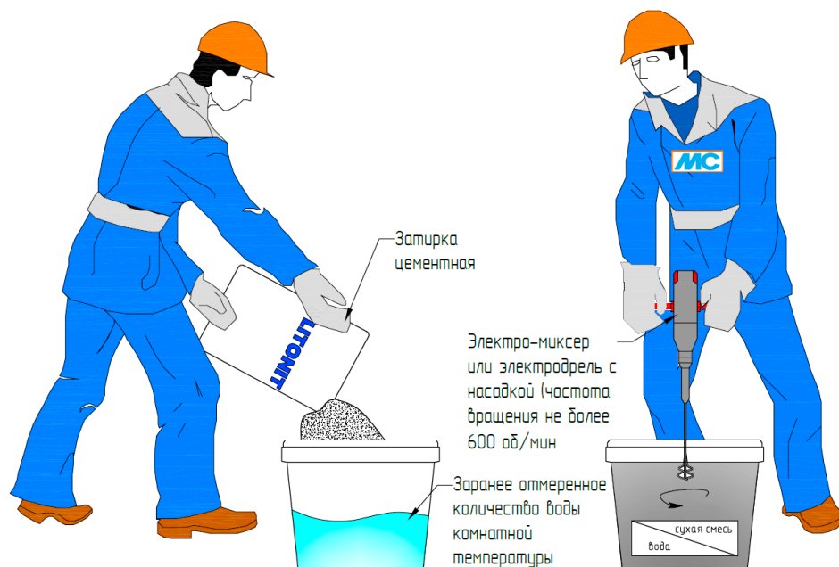
Рис. 13. Приготовление состава
