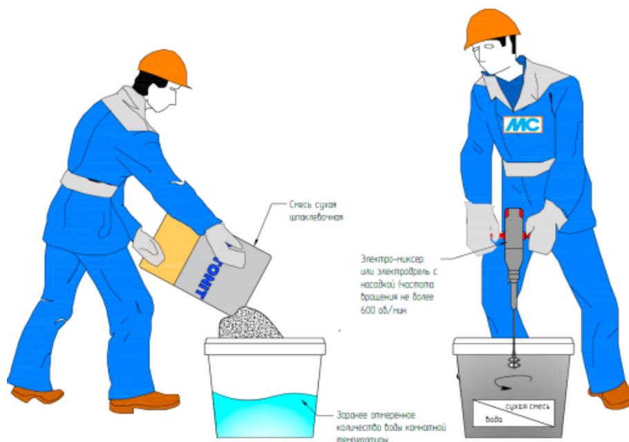
Рис. 20. Организация работ по затворению сухой шпаклевочной смеси
