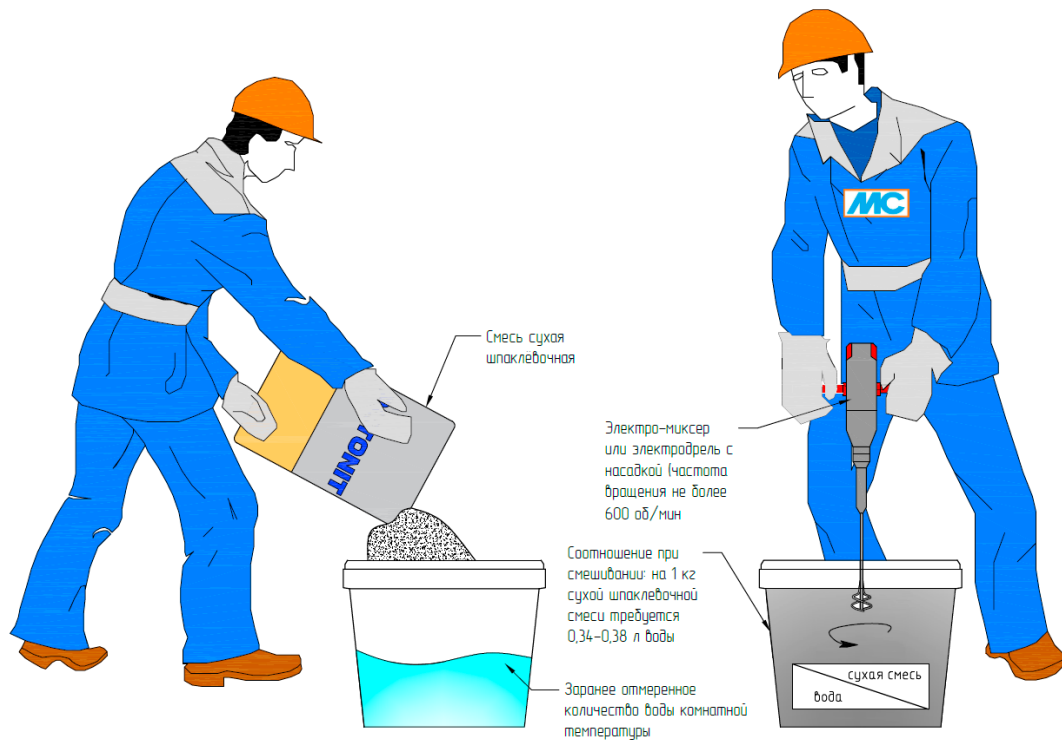
Рис. 12. Организация работ по затворению сухой шпаклевочной смеси
