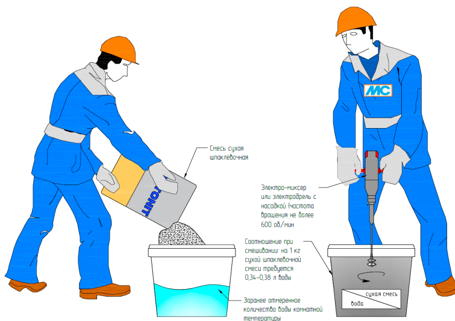
Рис. 25. Организация работ по затворению сухой шпаклевочной смеси
