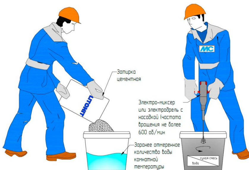
Рис. 34. Приготовление состава
