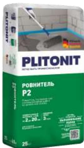
Продукт предназначен для выравнивания и корректирования бетонных полов и монолитных цементных стяжек внутри жилых и конторских помещений под укладку напольной керамической плитки, выстилающих покрытий и паркета, а также использования в системе «теплый пол». Рекомендуемая толщина слоя при выравнивании — 2-20 мм, в углублениях — до 30 мм. Температура покрытия в процессе эксплуатации — от +5°C до +70°C. Не подлежит окраске и использованию без напольного покрытия.
