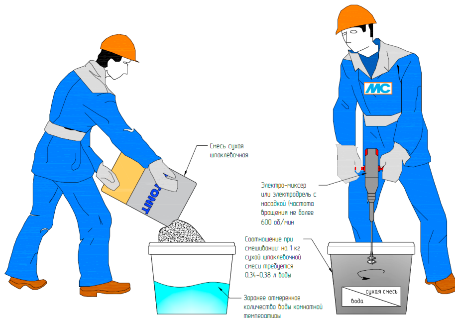
Рис. 19. Организация работ по затворению сухой шпаклевочной смеси
