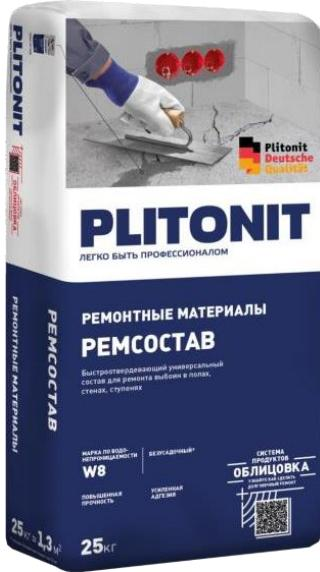
Mahsulot ichki va tashqi ishlarni bajarish jarayonida beton, temirbeton, g'ishtdan vertikal va gorizontal yuzalarni ta'mirlash va tekislash uchun mo'ljallangan. Tekislashda tavsiya etiladigan qatlama qalinligi 5 dan 50 mm gacha (chuqurliklarda 80 mm gacha). Foydalanish jarayonida qoplama harorati – +70 °C gacha. To'ldiruvchining maksimal fraksiysi – 2,5 mm.
