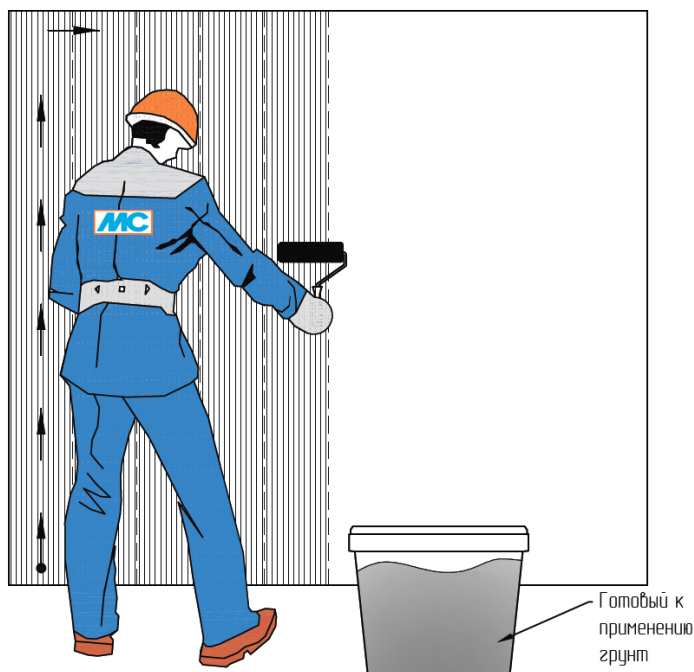
Рис. 12. Схема организации работ по нанесению грунта на основание
